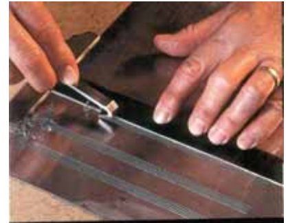
Die Basis für den Notenstich wird gelegt: Mit dem fünfzähligen Rastral zieht Hans Kühner zuerst die Notenlinie in die Bleiplatte
