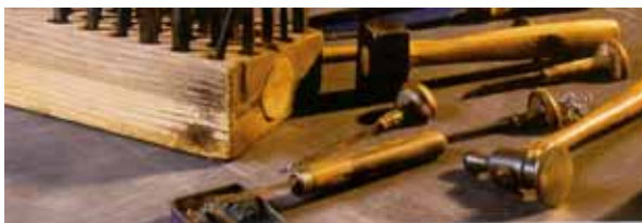
Hammer, Stempel und Stichel - das sind die traditionellen Werkzeuge des Notenstechers
